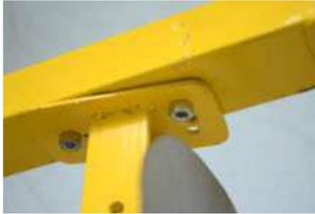
Figura 12. Detalhe da fixação do pedestal do disco ao chassi no maior ângulo horizontal.
