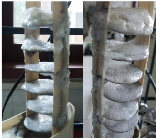
Figura 5. Deposição de sólidos – eletrofloculação.
