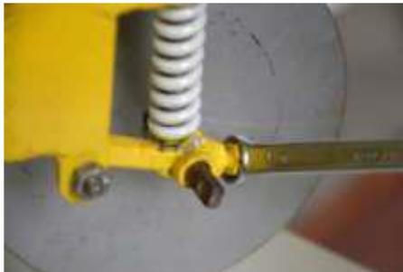
Figura 7. Detalhe da liberação do eixo da roda.
