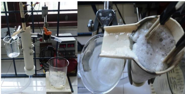
Figura 6. Reator tubular em funcionamento, sob o processo da eletrofloculação.
