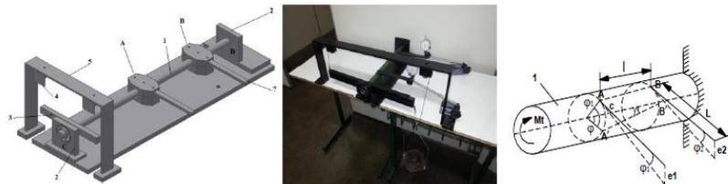
Figura 4. Equipamento fabricado para ensaio de Torção em barras circulares e diagrama de análise dos deslocamentos, respectivamente.
